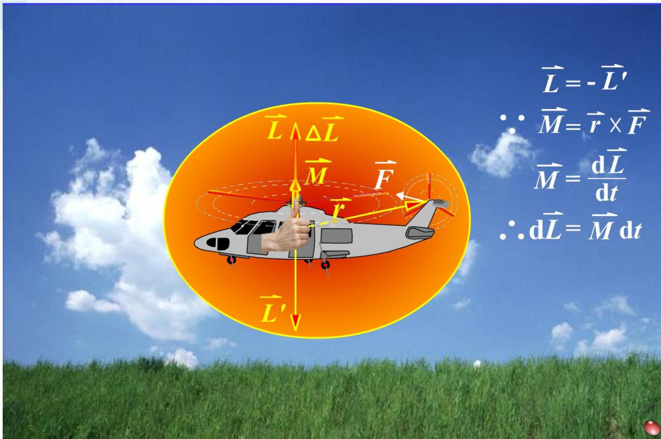
为了防止机身的反向旋转，在机身尾部装一个在竖直平面内旋转的尾桨，由它来产生一个水平推力，使系统受到一个向上的推力矩。以平衡单旋翼所产生的机身的反向旋转了。
