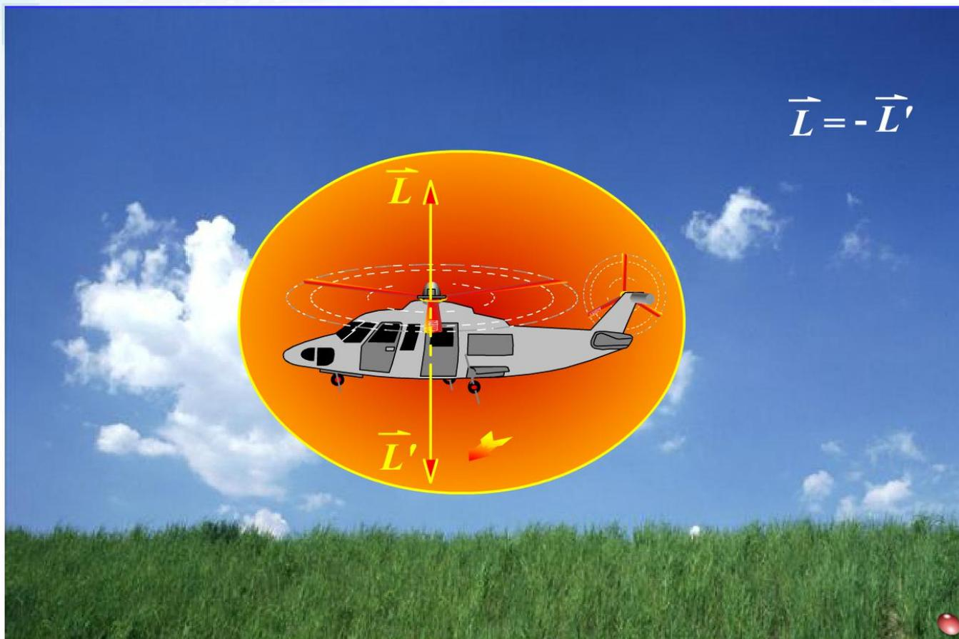
根据角动量守恒定律，系统的总角动量必须仍是零. 这种情况下，会出现了另一个大小相同而方向相反(向下)的角动量，机身要作危险的反向旋转.
