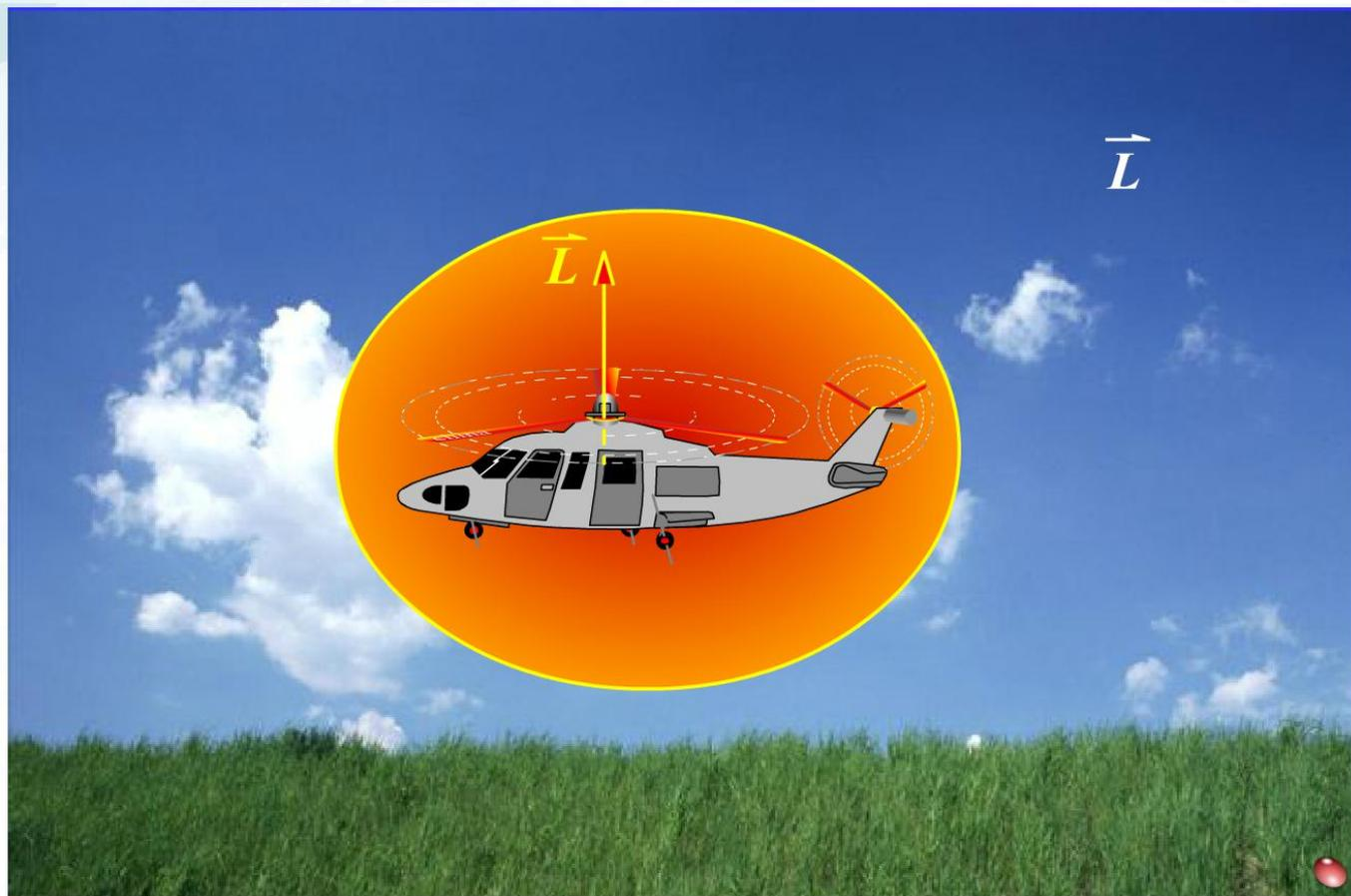
直升机在发动前，系统的总角动量为零. 一旦发动，旋翼在水平面内高速旋转，系统内出现了一个**竖直向上的角动量**.
